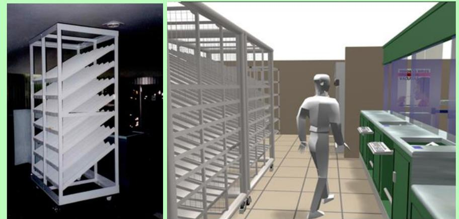
Un elemento de nuevo diseño fue el despachador para los medicamentos de alto consumo, diseñado por mí, que permite al personal, entregar las medicinas de forma rápida, sin tener que recorrer los largos y alejados anaqueles.
